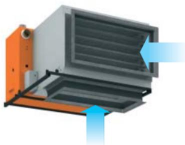
Воздухонагреватель поставляется на специальной стальной раме для перемещения и возможной опоры для устройства. Выходной раструб оснащен фланцем для крепления антивибрационной прокладки, которая будет расположена между воздухонагревателем и воздуховодами для горячего воздуха, которые должны иметь соответствующие размеры.
