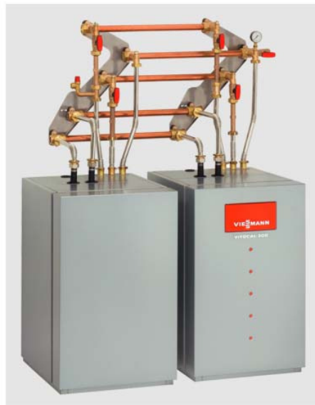
Двоступеневий тепловий насос Vitocal 300-G – готовий комплект в тепловій ізоляції з трубними з'єднаннями, запірною арматурою, циркуляційними насосами, запобіжним клапаном, манометром і стіновим кріпленням
